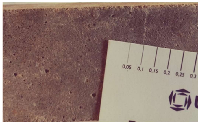
Figura 5 – Cicatrização de fissura aos 42 dias (microrganismo encapsulado em alginato (1,5% m/v) e mergulhado em água com ureia).
