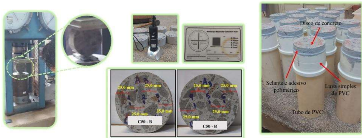
Figura 1 - Infográfico da preparação das amostras e dispositivo para o teste de percolação de água
