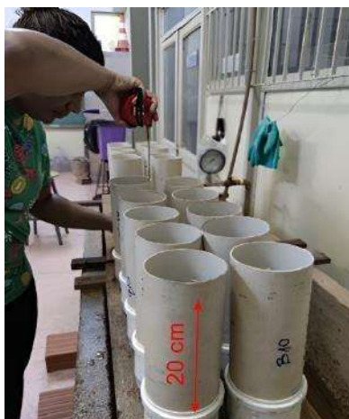
Figura 2 - Foto do ensaio de percolação de água
