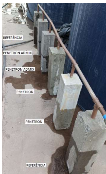
Figura 3 – Amostras no início da carga d'água – controle de fluxo
