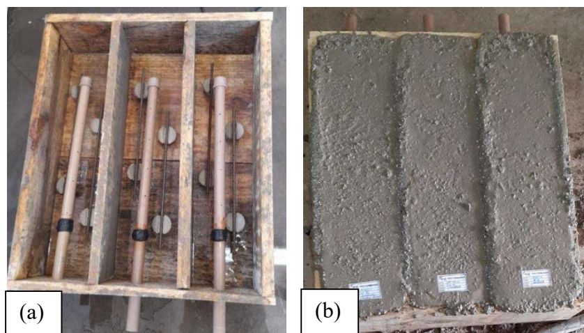
Figura 1 – Fôrma prismática com tubo, fita hidroexpansiva, armadura e espaçadores cimentícios (a); concretagem com traço referência (b)
